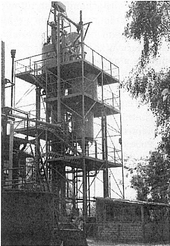
Instalacja doświadczalna pirolizy fluidalnej węgla
