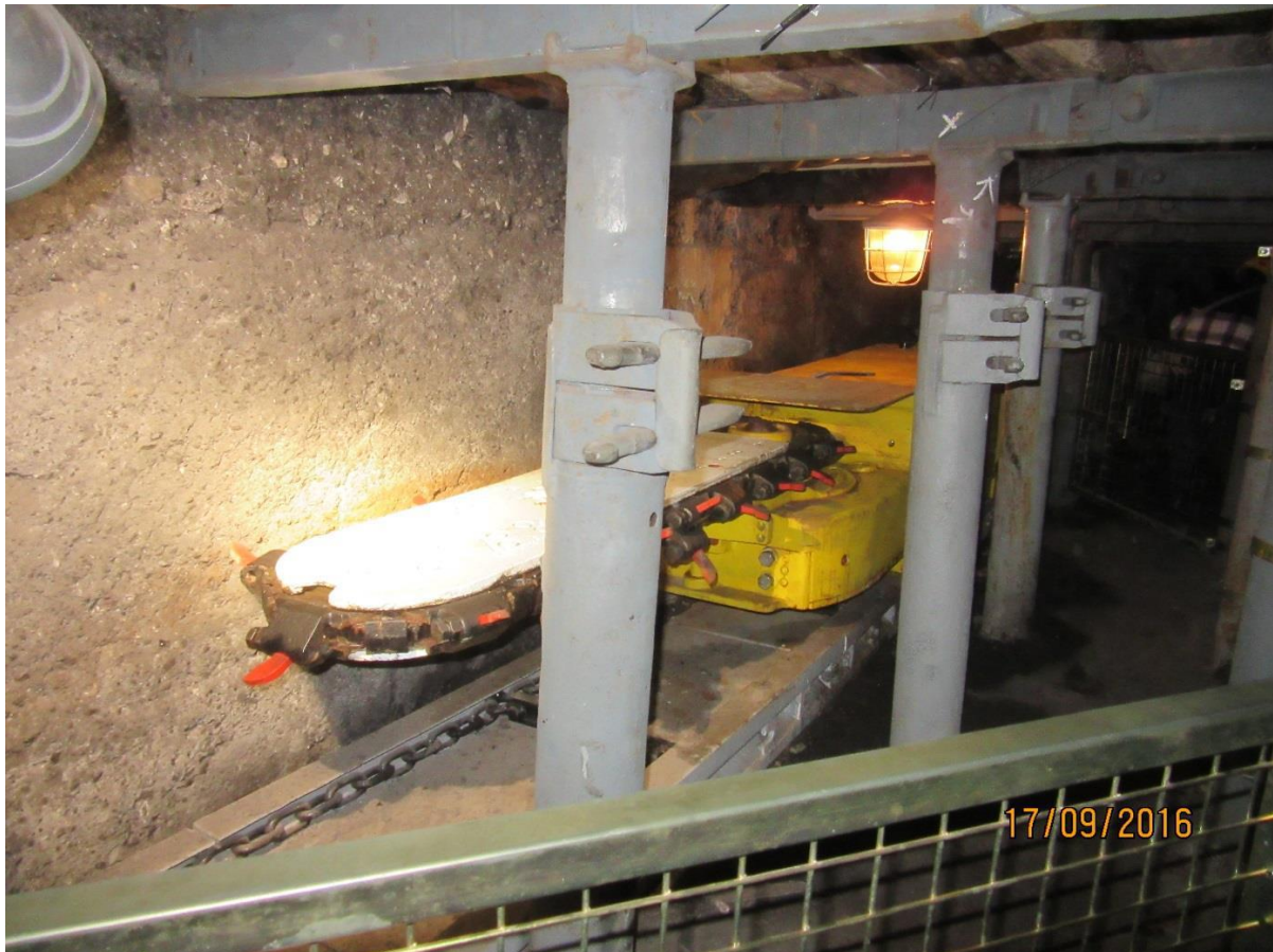
Nadal sprawna wrębiarka ścianowa produkcji Piotrowickiej Fabryki Maszyn w Skansenie Górniczym „Królowa Luiza”.
