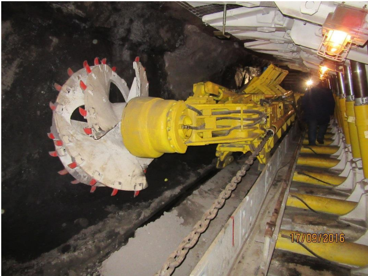
Kombajn KWB-3RDU w ścianie Skansenu Górniczego „Królowa Luiza” w Zabrze. Wszystkie urządzenia ściany, w tym kombajn, są sprawne.
