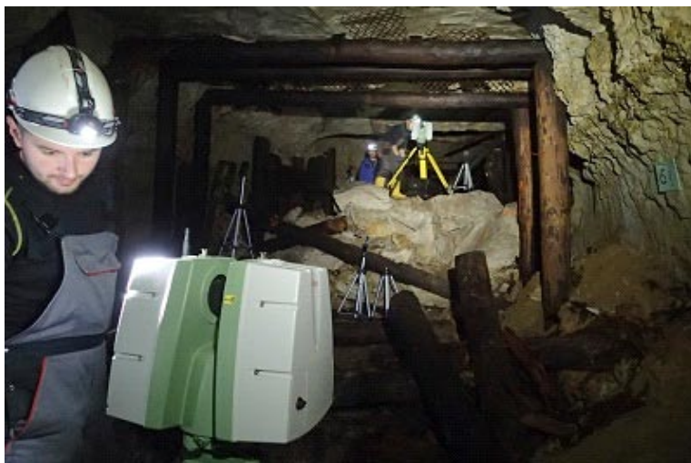
Ryc. 1. Skanowanie 3D w kopalni fosforytów w Annopolu (fot. A. Komorowski)
