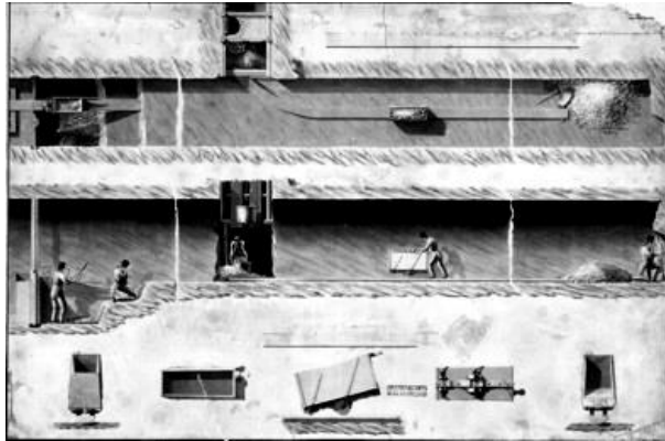
Rys. 3. Schemat drążenia Głównej Kluczowej Sztolni Dziedzicznej. Fig. 3. A diagram of the adit boring the Main Hereditary Key Adit.
