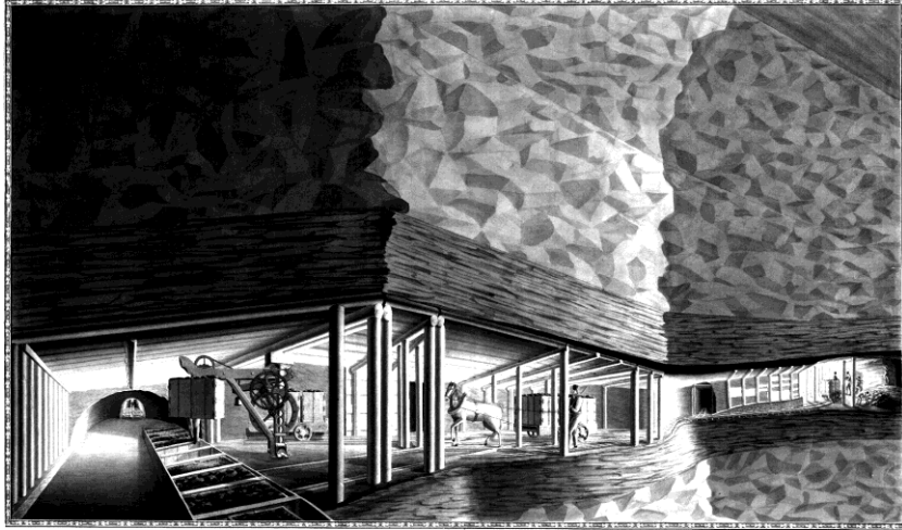
Rys. 6. Widok portu załadunkowego i dźwigu do ładowania skrzyń z węglem na łodzi w rejonie pokładów poziomych.
