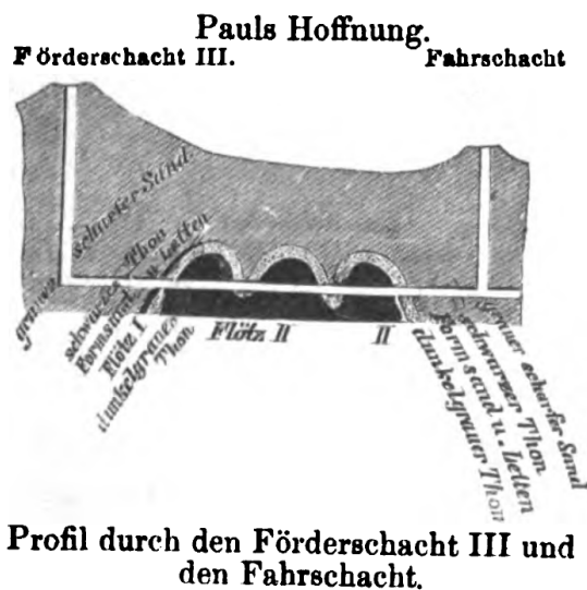
Ryc. 11. Schematyczny przekrój przez eksploatowane złoża w kopalni „PaulsHoffnung”. Źródło: ZinckenC.F., 1867. Die Physiographie der Braunkohle , Leipzig.
