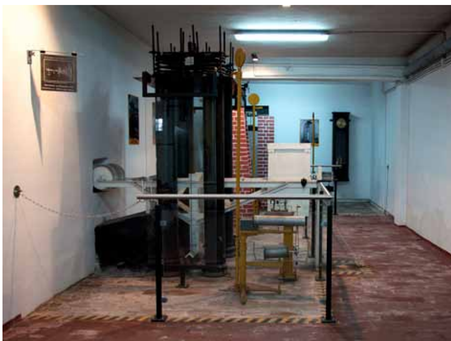
▣ Piwnica obserwatorium z sejsmometrami Mainki
