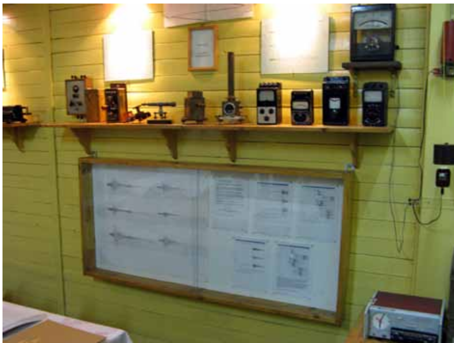
▣ Kolekcja galwanometrów używanych do zapisu sejsmogramów na papierze światłoczułym
