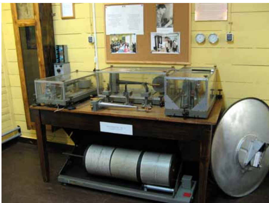
▣ Sejsmometry elektrodynamiczne zbudowane po II wojnie w warsztatach obserwatorium
