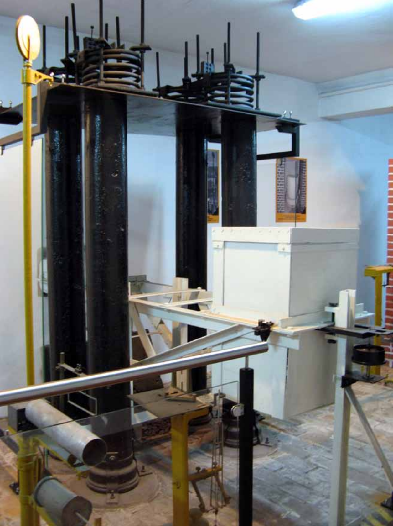
Unikalny sejsmometr pionowy Mainki z 1928 r. Był używany do rejestracji do 1997 r.
