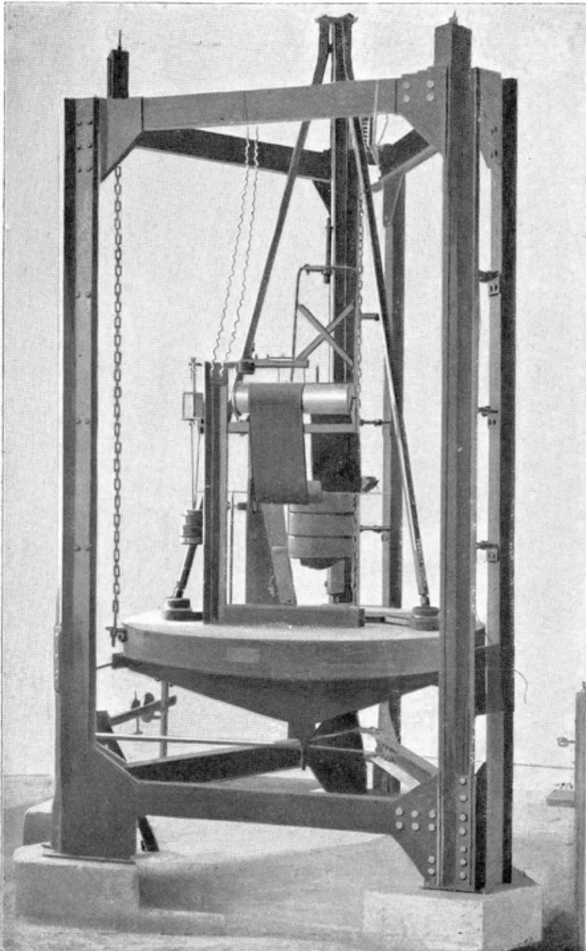
■ Płyta badawcza do testowania i kalibracji sejsmometrów konstrukcji Mainki
