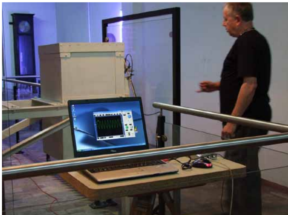
▣ Geofon zastosowany do elektronicznego powiązania z sejsmometrem pionowym Mainki
