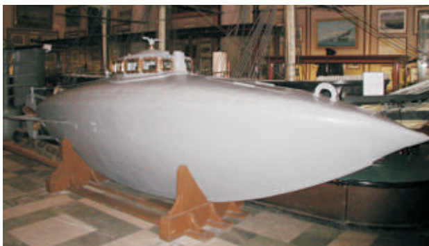
Okręt podwodny Stefana Drzewieckiego w Muzeum Marynarki w St. Petersburgu; pierwszy budowany w serii (50 egz. od 1881 r.), w 1883 skierowany na wyposażenie (pierwszej z powstałych w świecie) floty podwodnej Cesarstwa Rosyjskiego
