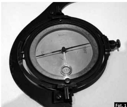
Fot. 1. Kompas górniczy produkcji F.Breithaupt, Kassel, 1809 r. Fot. S. Gierlotka
