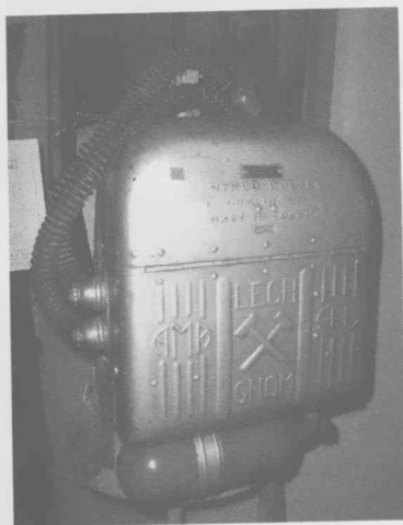
Tlenowy aparat roboczy „Lech-Gnom”, 1939 r. Fot. Jan Woźniak, zabytek ze zbiorów Izby Tradycji Fabryki Sprzętu Ratunkowego i Lamp Górniczych „FASER” w Tarnowskich Górach
