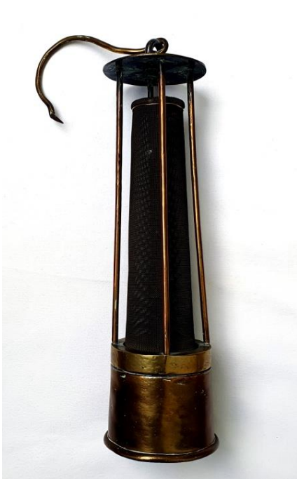
1883 Franz Pieler Sicherheitslampe mit Drahtkorb-Filter
