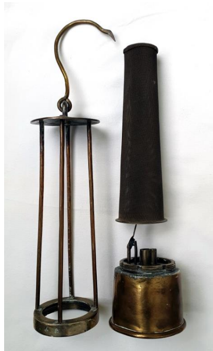
1883 Franz Pieler Sicherheitslampe mit Drahtkorb-Filter
